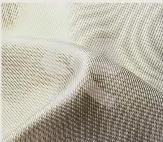
TenCate Mirafi® PET 系列土工布是用于长期设计寿命土体加筋的工程材料。其由高强度聚酯纤维组成，强度高、应变低，同时在长达 120 年的整个工程设计寿命期间蠕变极小。在土体中加入 TenCate Mirafi® PET 系列土工布可以增强土体的抗剪强度，从而改善其结构能力。使用 TenCate Mirafi® PET 系列土工布建造的土体工程包括：
